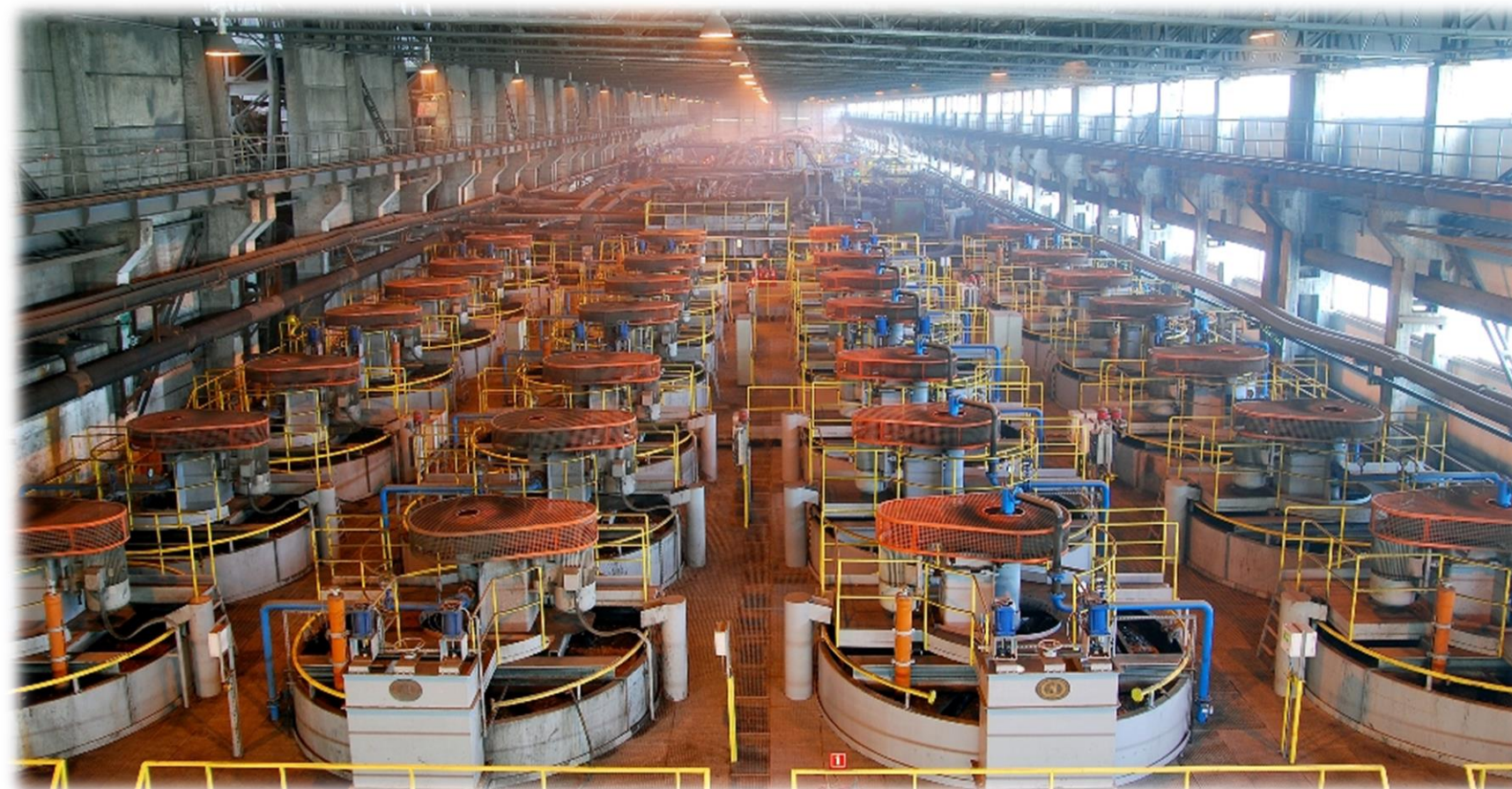
Maszyny flotacyjne typu IF pracujące w KGHM S.A. – projekt oraz opracowanie konstrukcji zrealizowane w Centrum Przeróbki Surowców Mineralnych
